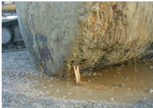
Site pollué par des hydrocarbures, assaini lors de la construction d'un nouvel immeuble en ville de Fribourg (la citerne percée était enfouie dans le sol)
