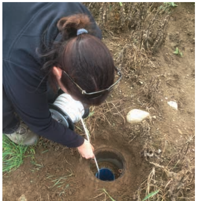
Investigation sur une ancienne décharge (prélèvement d'eaux souterraines)
