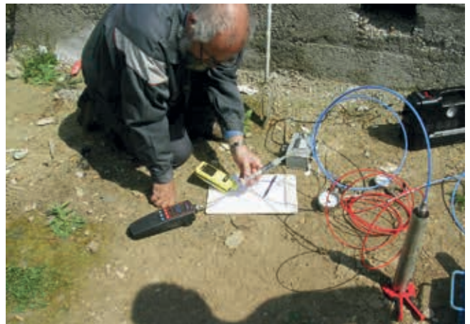
Investigation sur une ancienne aire d'exploitation (prélèvement de terre et contrôle de l'air interstitiel)
