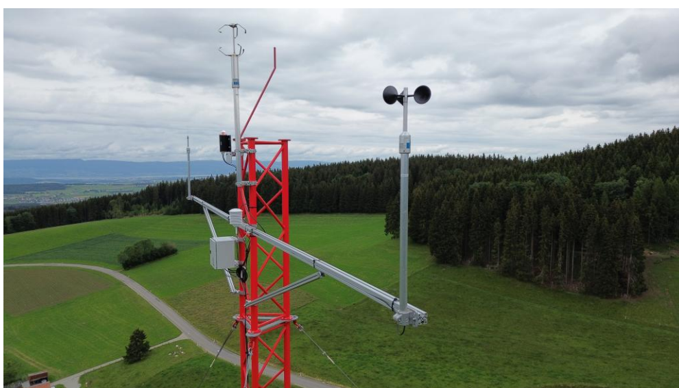
Figure 6: En haut : Photographie montrant le mât en intégralité (100 mètres de haut). En bas : Zoom sur les capteurs au sommet du mât. Les données du capteur Ultrasonique 3D installé au sommet du mât au milieu sur la photo sont utilisées comme référence pour le calcul des productibles.
