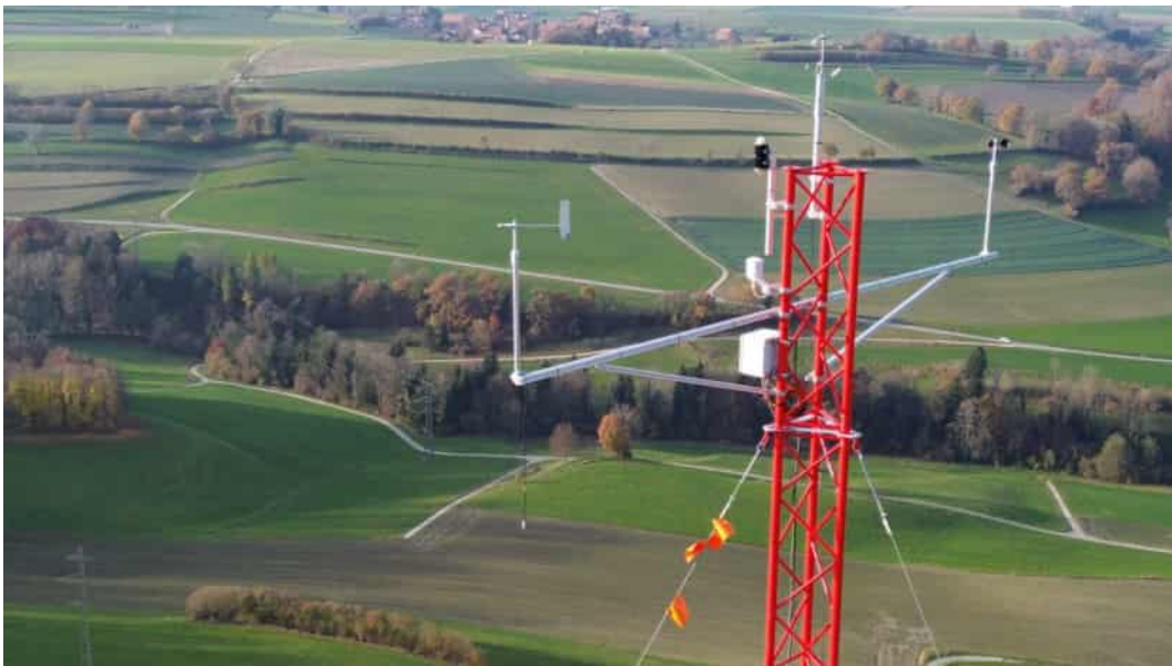
Figure 6: En haut : Photographie montrant le mât en intégralité (100 mètres de haut). En bas : Zoom sur les capteurs au sommet du mât. Les données du capteur Ultrasonic 3D installé au sommet du mât au milieu sur la photo sont utilisées comme référence pour le calcul des productibles.
