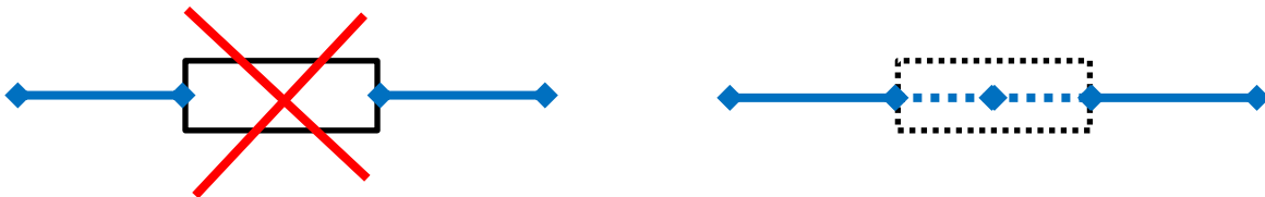
Figur 3 : Ersatz eines Polygons durch einen Punkt und zwei internen Leitungen
