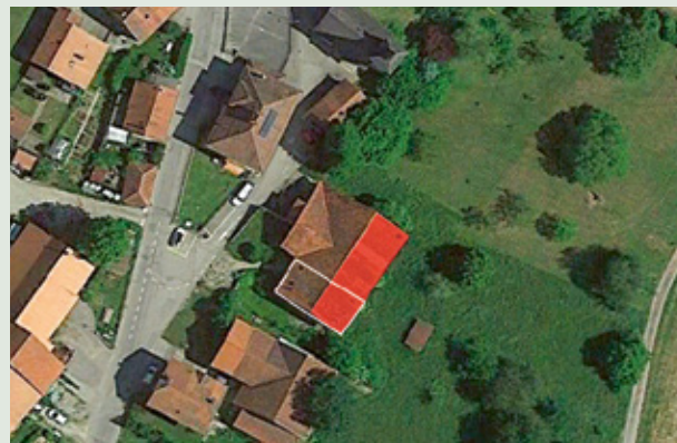
Emplacement possible pour la pose de capteurs photovoltaïques ne portant pas atteinte au site bâti.
