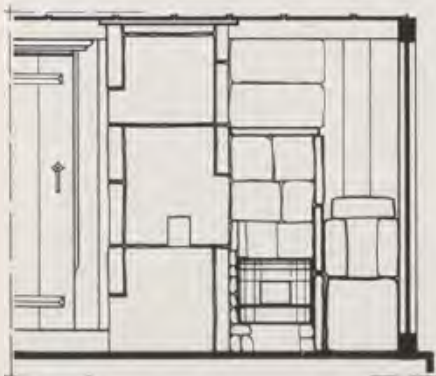
789 Detail: Feuerstelle 1:50 (Kamin, Herd, Aschenloch)
