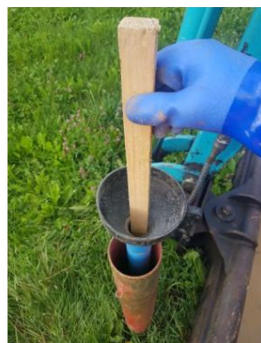
Exemple de remplissage d'un tube avec de la bentonite
