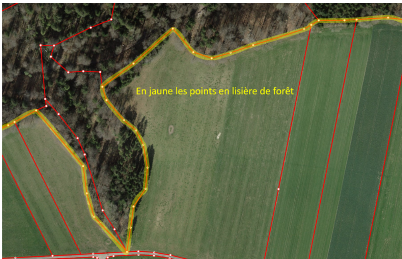
FIG. 10.5 : Détermination des points limites en lisière de forêt
