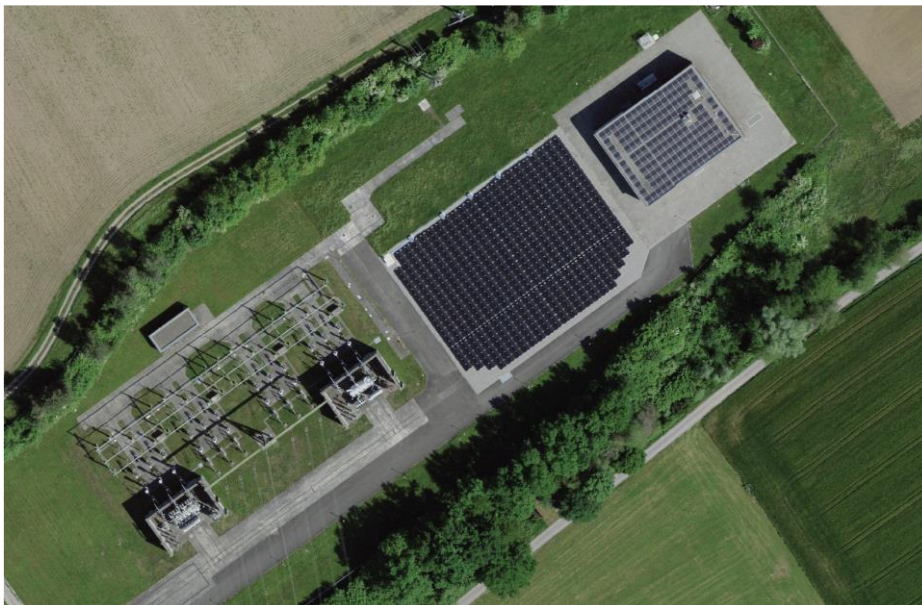
Illustration 21 : Installation photovoltaïque de 332 kW à la Schönau à Baar (ZG), mise en service le 27 octobre 2020. L'installation a été posée sur un revêtement dur du site de la sous-station Altgasse gérée par Wasserwerke Zug et Axpo. Les modules photovoltaïques sont orientés est-ouest. Photo aérienne : map.geo.admin.ch .
