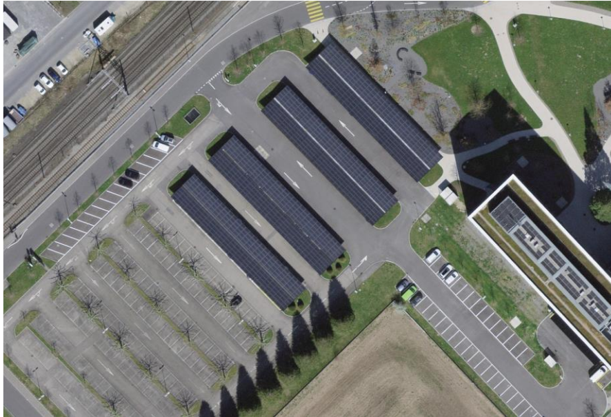
Illustration 18 : Installation photovoltaïque de 328 kW à la Zugerstrasse 13 à Ebikon (LU), mise en service le 15 mars 2019. L'installation est composée de toits creux sur le parking de l'entreprise Schindler Aufzüge AG et couvre environ 5% du courant consommé sur le campus. Photo aérienne : map.geo.admin.ch.
