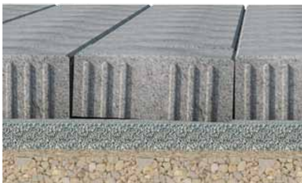
Figure 23: Légère déformation due aux efforts de cisaillement en présence de pavés épais
