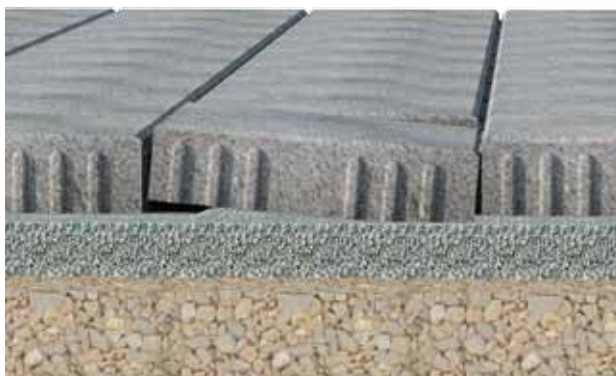
Figure 24: Forte déformation due aux efforts de cisaillement en présence de pavés minces
