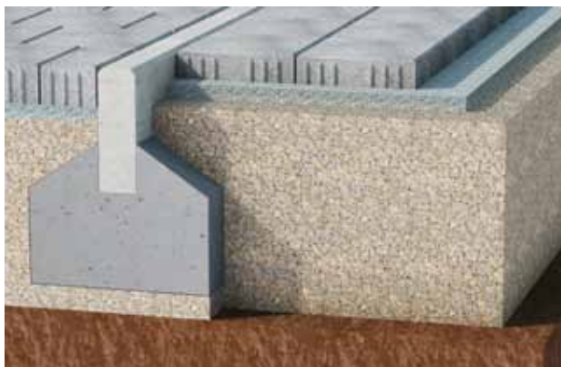
Figure 28: Transition avec bordurette en béton
