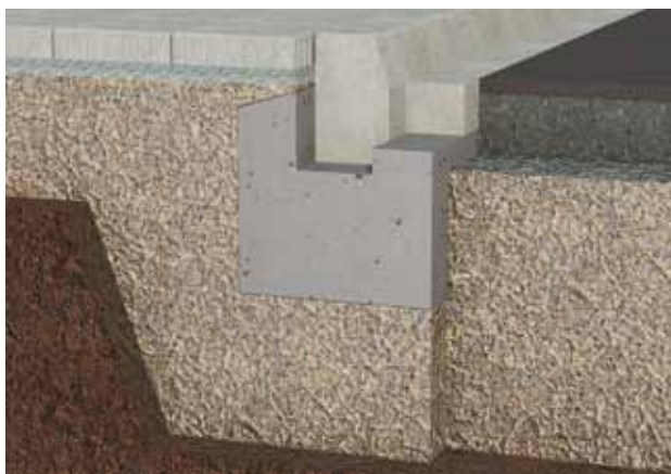
Figure 11: Transition avec bordures et pavés de marquage
