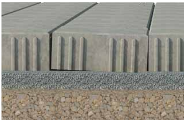
Figure 5: Légère déformation due aux efforts de cisaillement en présence de pavés épais
