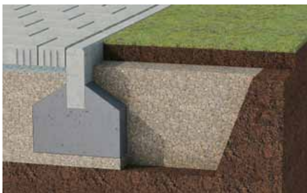
Figure 12: Transition avec une bordurette en béton
