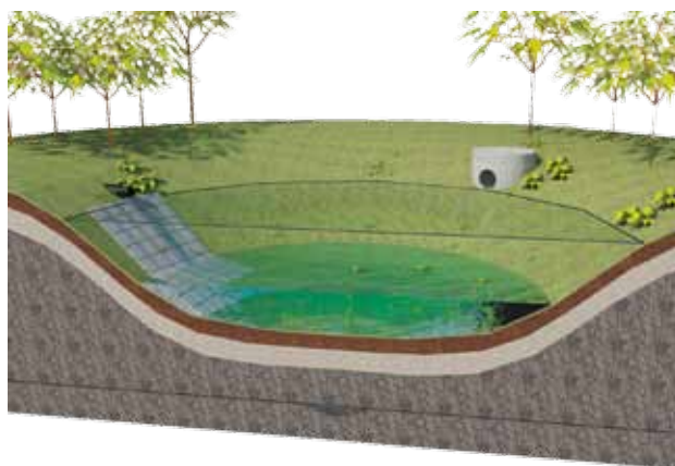
Figure 58: Infiltration dans une cuvette
