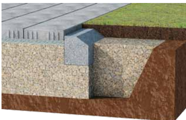
Figure 31: Bétonnage de bordure in situ
