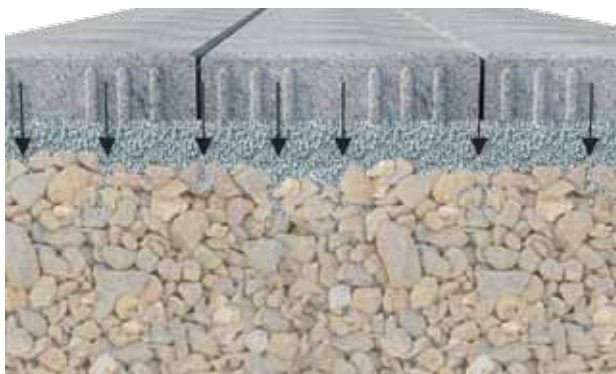
Figure 22: Perte du matériau fin du lit de pose dans la couche de fondation
