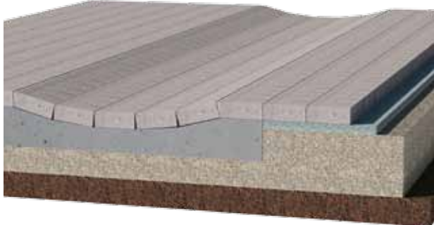
Figure 17: Caniveau de drainage en pavés
