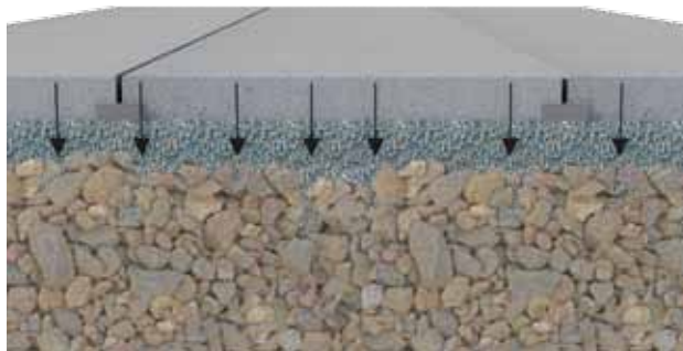
Figure 38: Perte du matériau fin du lit de pose dans la couche de fondation
