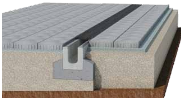
Figure 33: Caniveau de drainage dans le pavage
