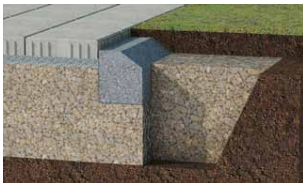
Figure 13: Bétonnage de bordures in situ
