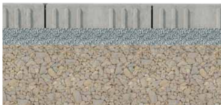
Figure 3: Coupe détaillée de la superstructure
