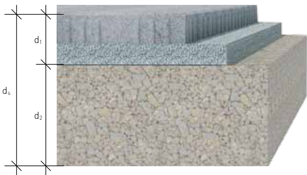
Figure 53: Détermination de l'épaisseur de la superstructure
