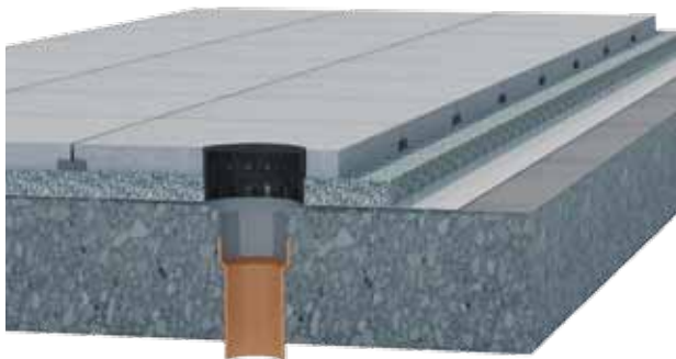
Figure 47: Drainage des toits plats et des terrasses
