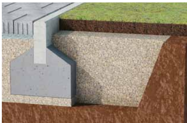
Figure 30: Transition avec une bordurette en béton
