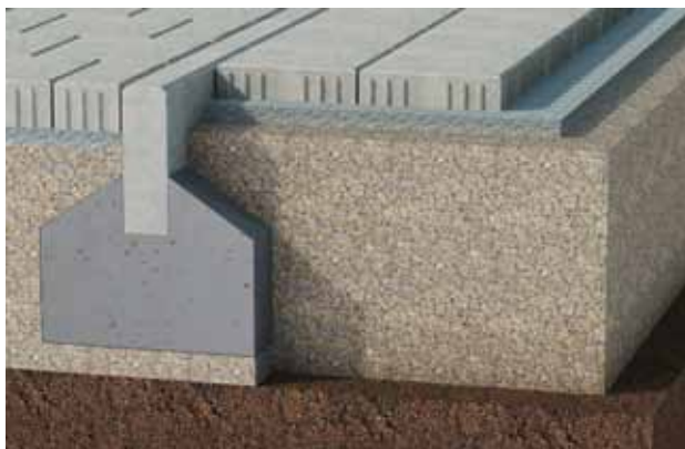
Figure 10: Transition avec bordurette en béton
