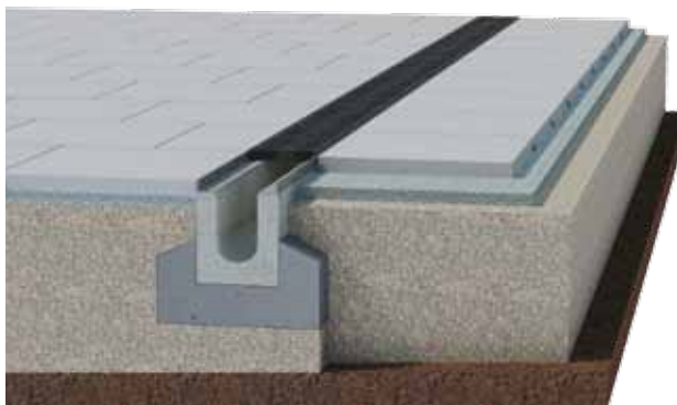
Figure 45: Caniveau de drainage dans le dallage
