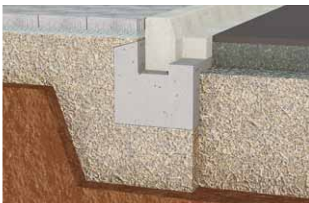
Figure 29: Transition avec bordure et pavés de marquage
