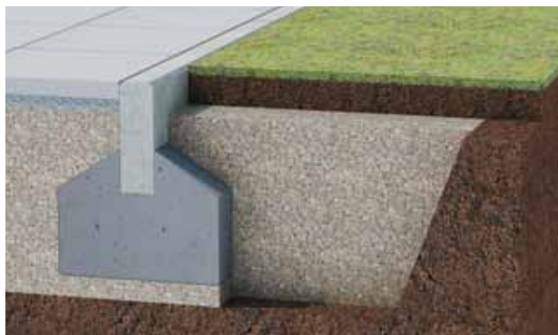
Figure 42: Transition avec une bordurette en béton
