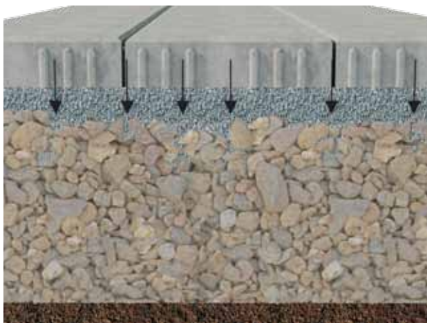
Figure 4: Perte du matériau fin du lit de pose dans la couche de fondation
