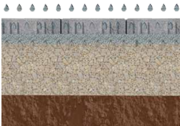
Figure 55: Evacuation de l'eau à travers le pavé filtrant
