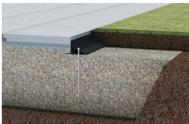
Figure 44: Profilé de bordure en matière synthétique PAVE EDGE
