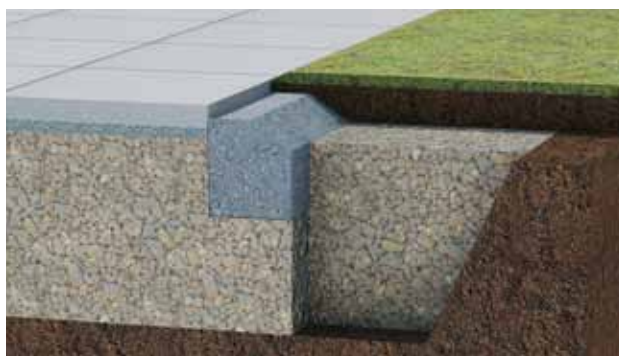
Figure 43: Bétonnage de bordure in situ
