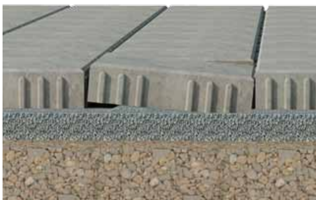
Figure 6: Forte déformation due aux efforts de cisaillement en présence de pavés minces
