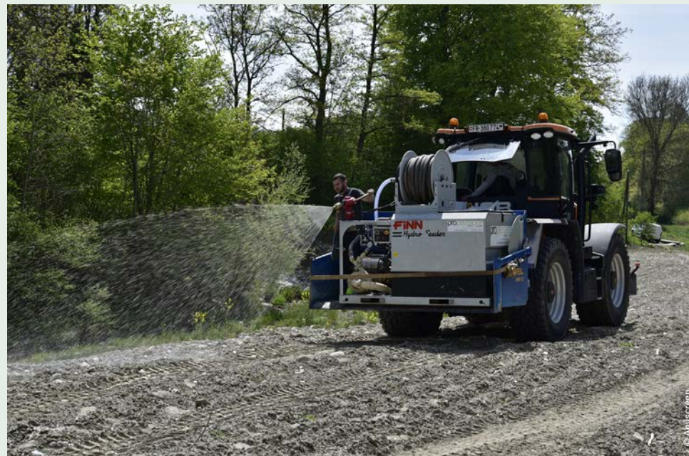
Ensemencement hydraulique pour lutter contre les espèces envahissantes et protéger le sol.
