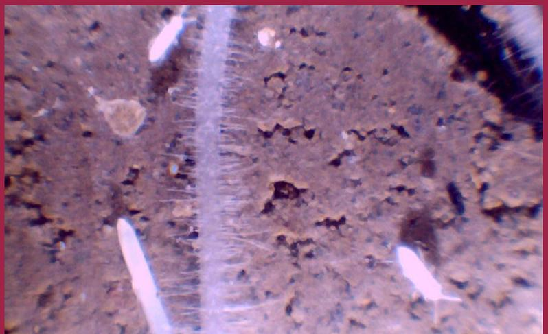
Grangeneuve verfügt über eine schonende Methode um das Wachstum der Wurzeln und das unterirdische Leben im Boden zu beobachten. Die Minirhizotron-Kamera erlaubt eine fünfzigfache Vergrößerung. Sie wird seit drei Jahren in der Aus- und Weiterbildung, bei thematischen Anlässen (z. B. Agripro 2013) und Feldübungen eingesetzt.
