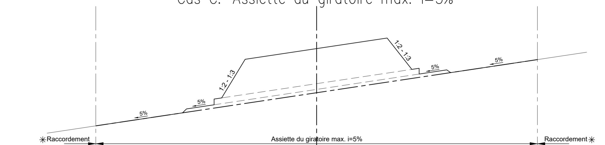
\* Les raccordements à l'assiette du giratoire sont définis avec une déclivité comprise entre la pente de l'assiette du giratoire et la pente de l'anneau de circulation. Si besoin, les éventuels rayons de raccordement verticaux définis pour une vitesse de projet Vp=40 km/h au minimum sont à implanter hors-assiette du giratoire.
