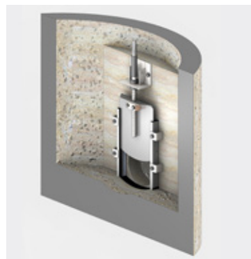
Figure 4 Vanne d'obturation à commande manuelle (Source: SISTAG)
