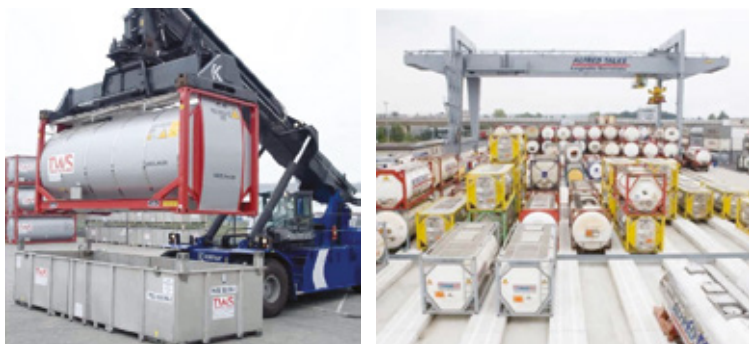
Figure 7 et 8 Etat de la technique en matière de stockage de conteneurs: Bac de rétention et terminal à conteneurs (Entreprise TALKE à Hürth, Cologne).
