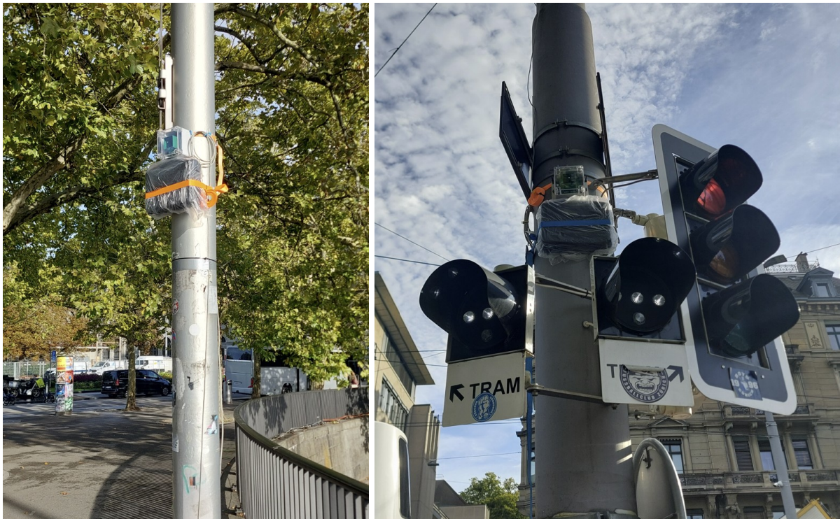
Abbildung 14: Vergleichsmessung mit ExpoM-RF 4 Geräten. Diese wurden wettergeschützt jeweils direkt unterhalb von S1, S7 und S12 montiert. Links: Parallelmessung bei S1; rechts Parallelmessung bei S12.
