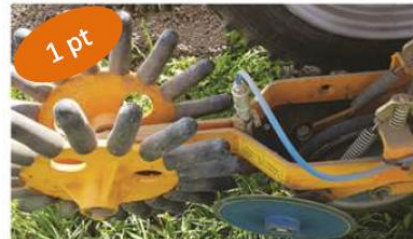
Pulvérisation en bande couplée au semoir ; source : SFZ
