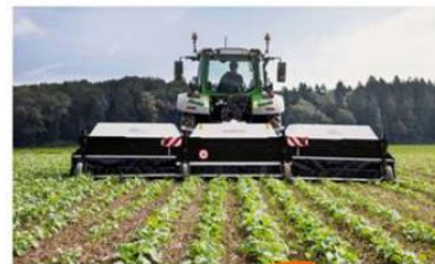
Exemple de traitement plante par plante par caméra ; source : Ecorobotix
