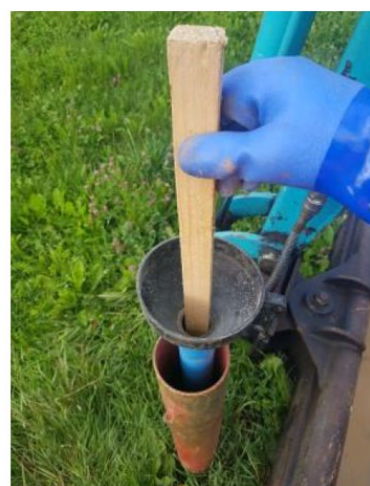
Beispiel für die Verfüllung eines Rohrs mit Bentonit
