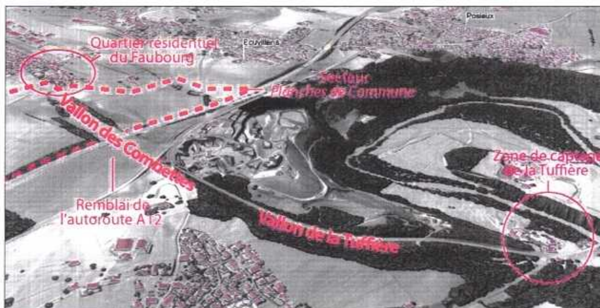
Figure 3: Modèle numérique de terrain montrant la continuité géomorphologique entre les vallons des Combettes et de la Tuffière, les deux n'étant entrecoupés que par le remblai (artificiel) de l'autoroute A12. Bien que portant des noms différents, ceux-ci ne sont en réalité qu'un seul et même vallon (Source: SwissSurface3D).
