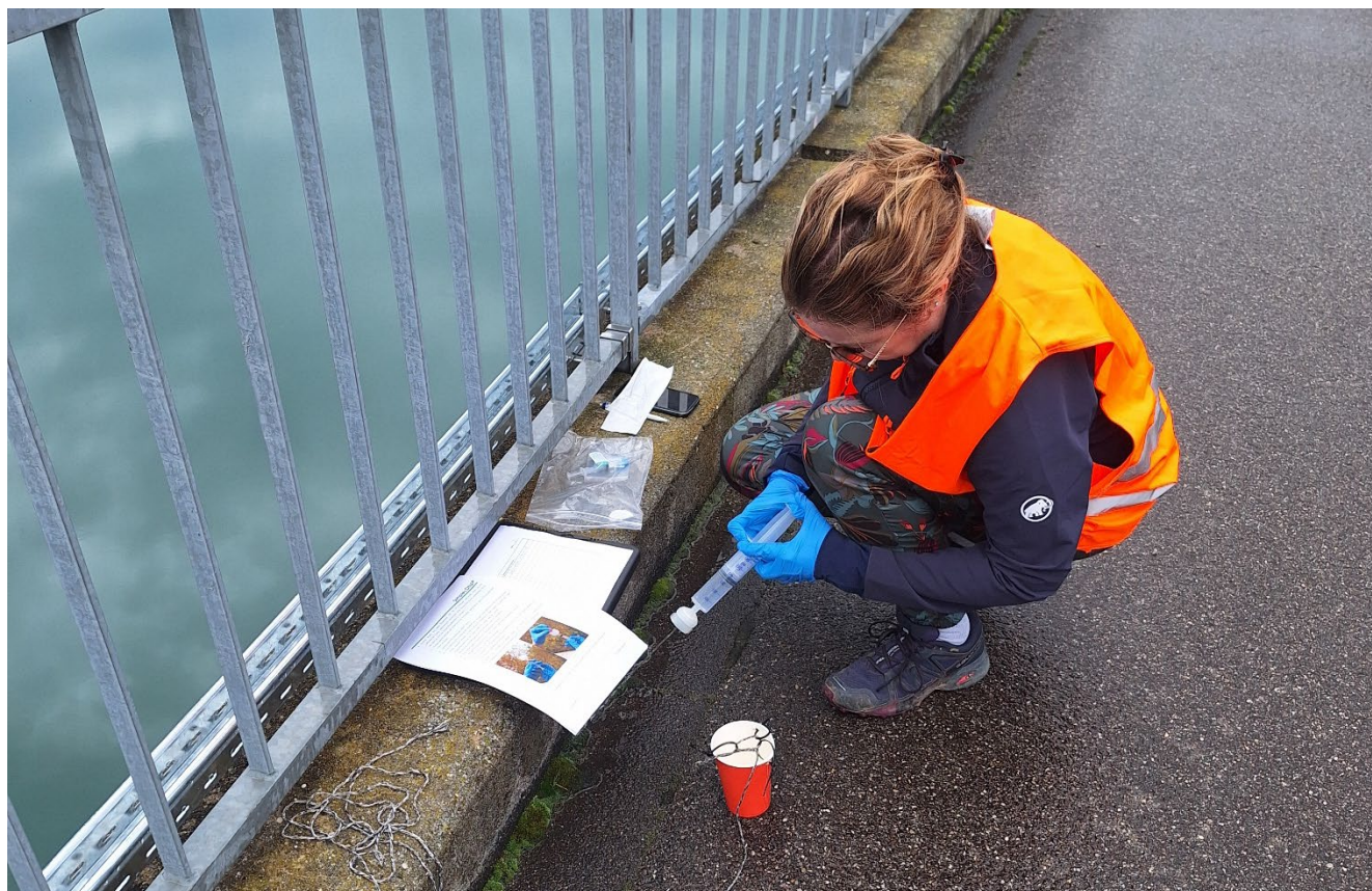
Probenahme in Freiburger Gewässer zur Überprüfung auf das Vorhandensein von DNA der Quaggamuschel. © AfU
