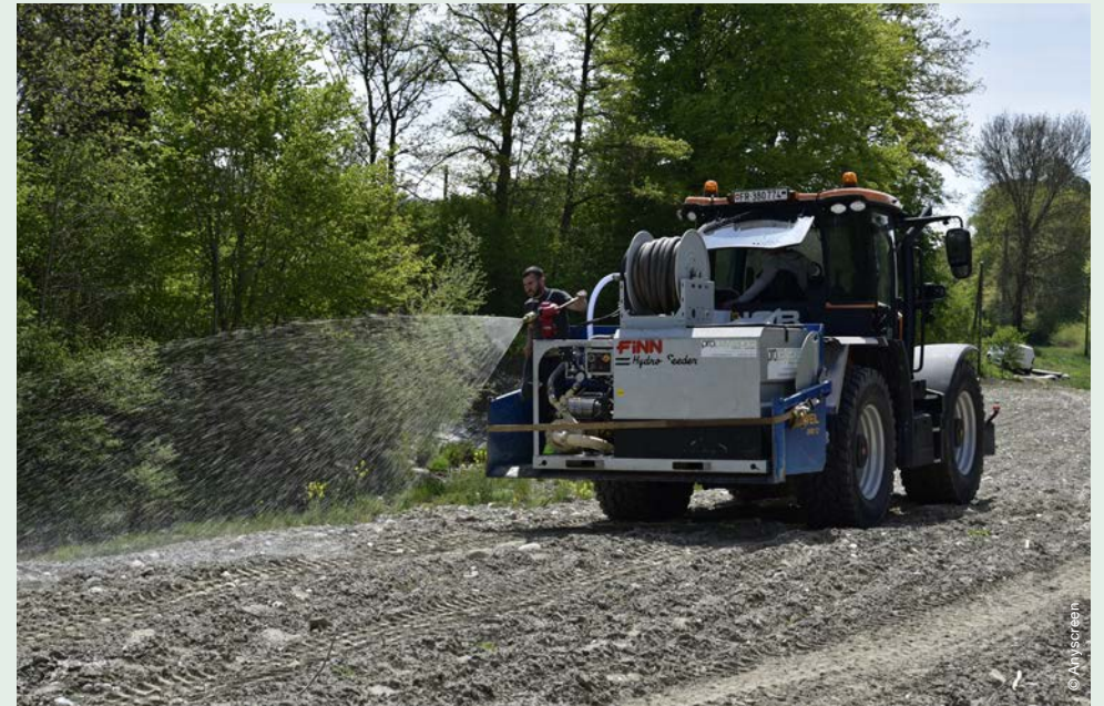
Hydraulische Ansaat zur Bekämpfung invasiver Arten und zum Schutz des Bodens.
