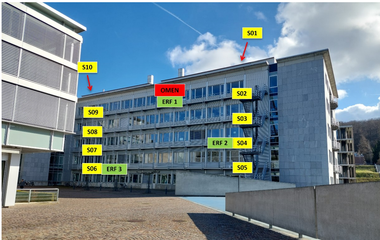
Abbildung 5: Anordnung vertikal, Platzierung der Sensoren (S01 – S10) und Positionen der ExpoM-RF Geräte für die Parallelmessung (ERF 1-3). Die Ausleseeinheit befindet sich im Liftmaschinenraum auf dem Dach des Gebäudes.
