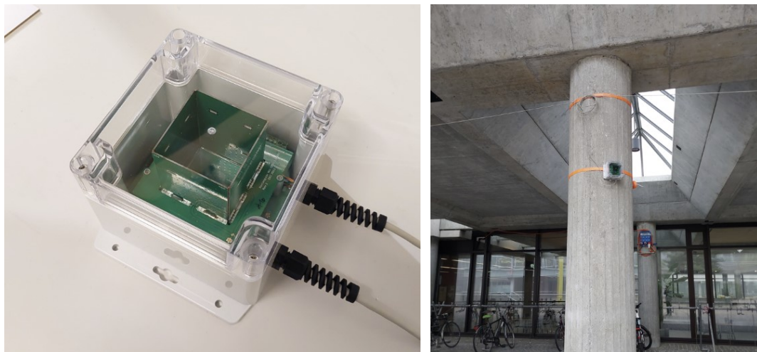
Abbildung 8: links: Sensor im witterungsgeschützten Gehäuse mit angeschlossenen Datenkabeln; rechts: Blick auf einen der montierten Sensoren im Messaufbau an der Universität Irchel.
