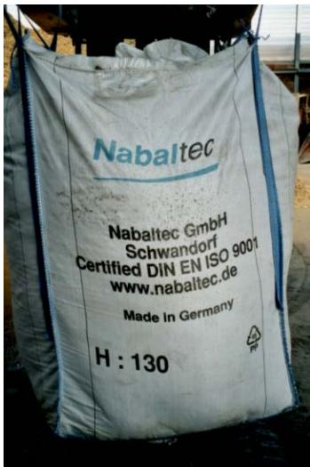
Les big bags, de forme rectangulaire, doivent avoir une dimension minimale de 110 cm de largeur (chaque côté) et de 130 cm de haut. Ils doivent être munis, aux 4 coins supérieurs, de passants (anneaux) permettant de les soulever au moyen d'une fourche hydraulique de tracteur. Dans la mesure où ils ne seront pas réutilisés, il n'est pas nécessaire qu'ils soient munis, à la base, d'une ouverture permettant de les vider lors de la séance de récupération des projectiles.
