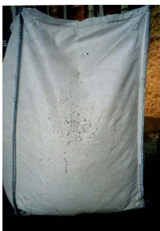
Lors des essais effectués en 2000, on a pu constater, à condition d'utiliser la bonne qualité de sac, que la partie frontale résistait sans autres à plus de 800 coups (photo ci-contre).
