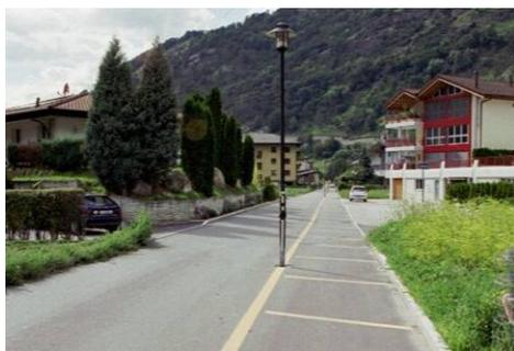
Les trottoirs non délimités par une construction (exemple : uniquement au moyen de peinture) ne sont pas à lever. Ces surfaces sont définies avec la surface de la route.
