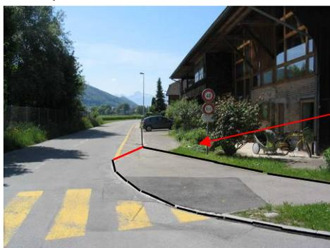
La fin du trottoir n'est pas définie par une construction. Au niveau de la transition avec la route, le trottoir est (exceptionnellement) séparé de la surface de la route par une ligne « fictive » (sans attribut de ligne).
