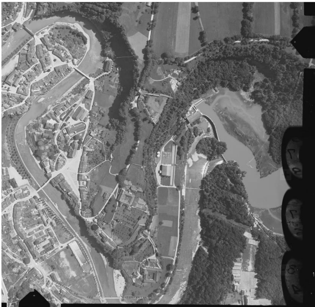
Luftaufnahme (1939). Der begradigte Lauf der Saane nach den Korrektionsarbeiten und dem Bau der Staumauer der Magerau © Swisstopo
