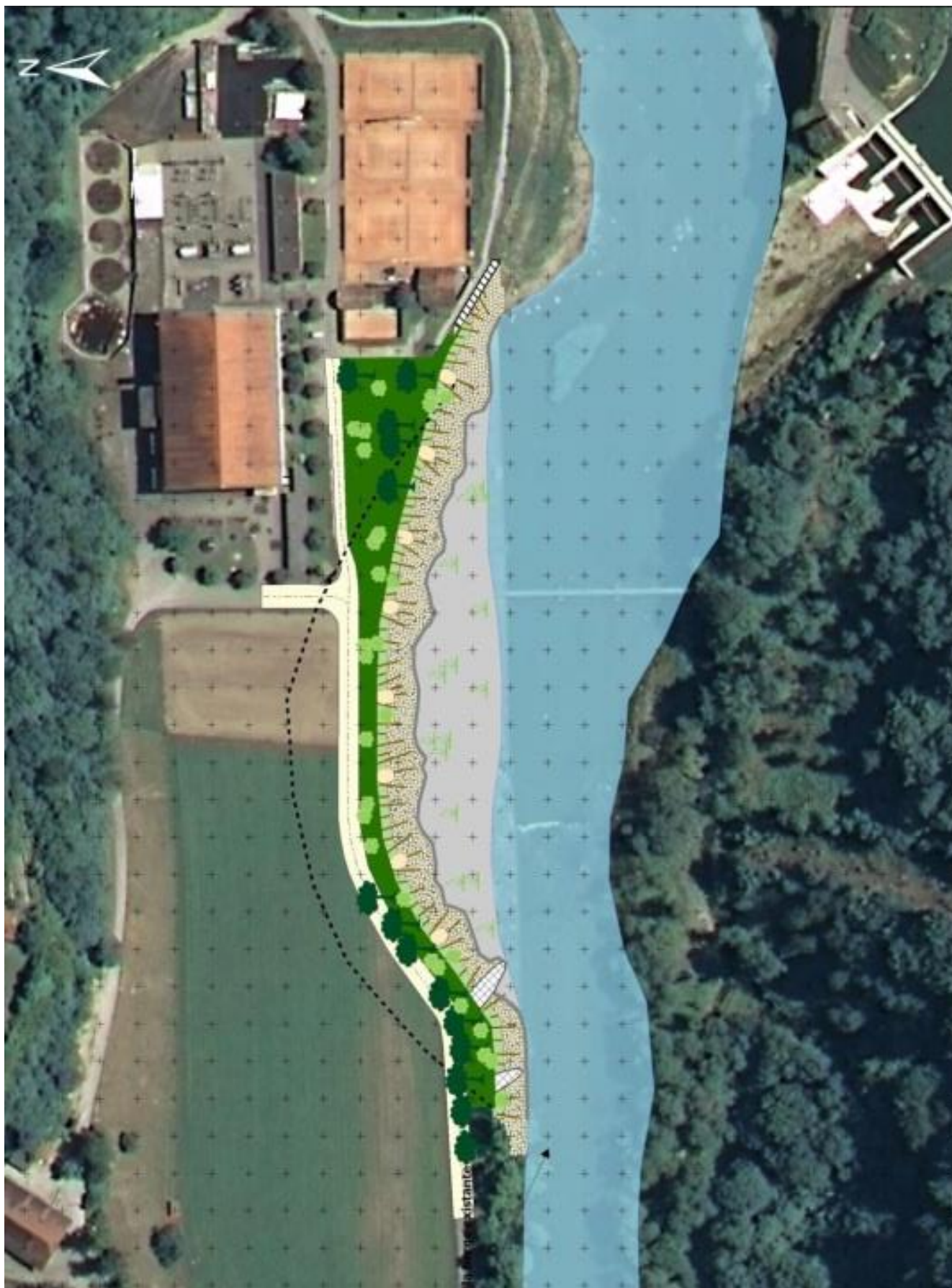
Konzept für eine Aufweitung und einen Uferschutz, die naturnaher sind © AfU
