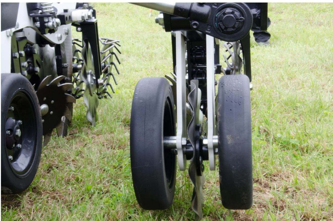
Figure 8 : Strip-till, littéralement « labour en bande » en anglais. Cette technique permet de ne travailler que la partie du sol qui va être semée. Source : Grangeneuve
