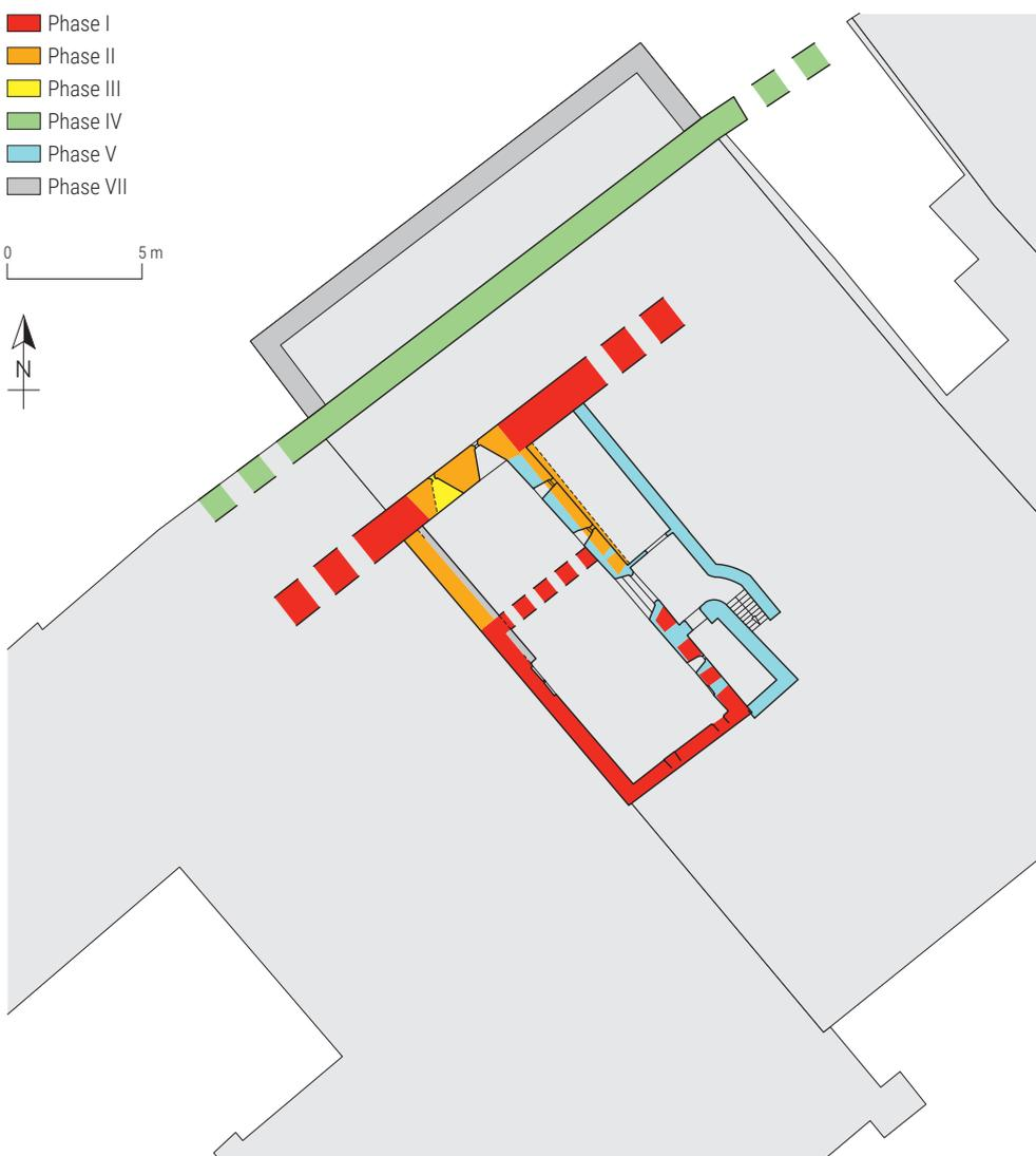
**Abb. 4** Planaufnahme des Kellers mit Eintragung der verschiedenen Bauphasen
