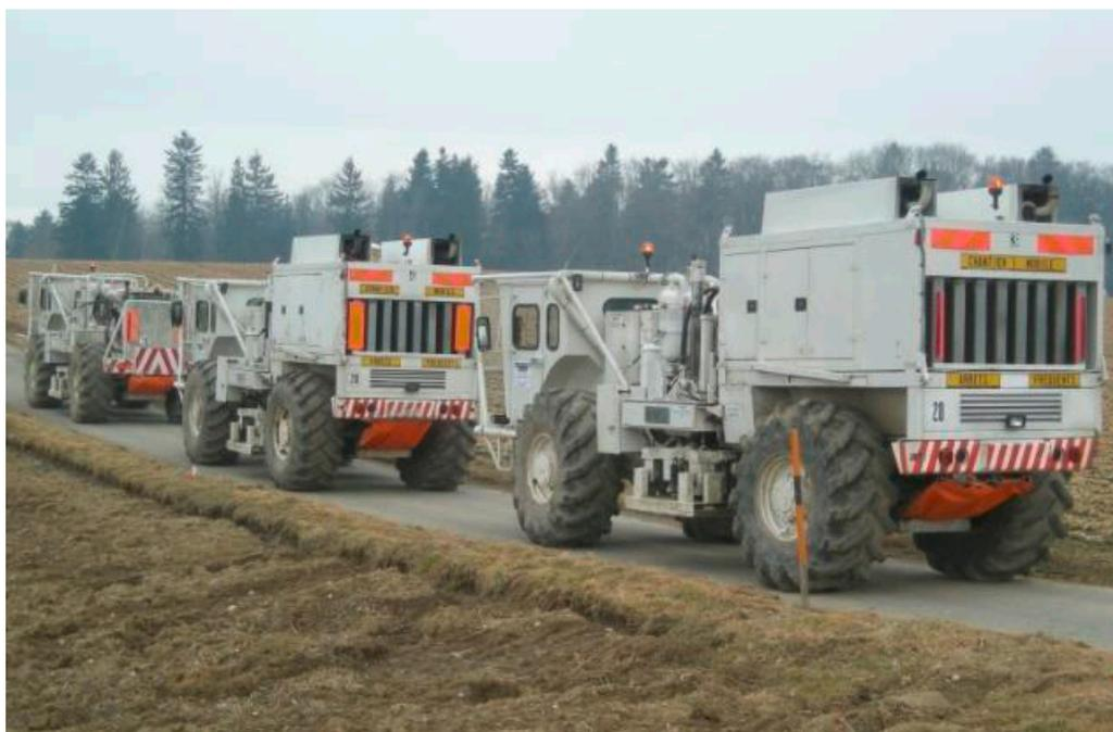
Véhicules pour mesures de sismique réflexion. Source: SwissTerraPower
